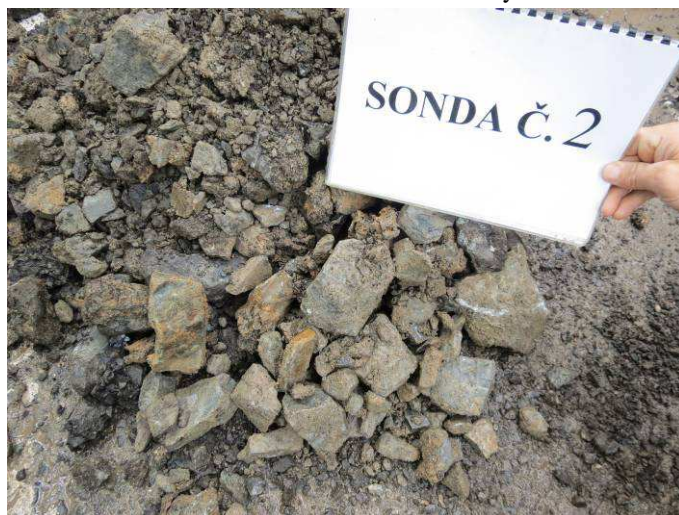
Obr.4.F Sonda č.2 - materiál konstrukční vrstvy
